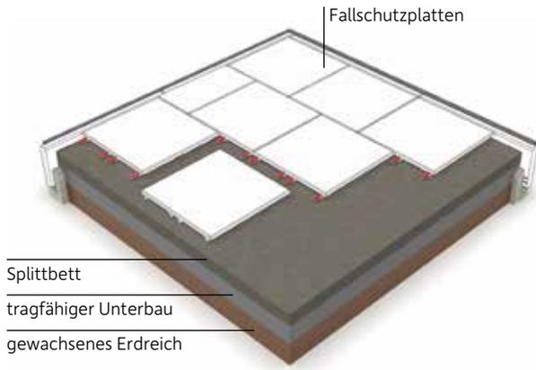
Verlegung (Halbverband) auf sickerfähigem Untergrund (Lava, Basalt, Schotter, Splitt) mit Einfassungselement und Systemsteckern.
