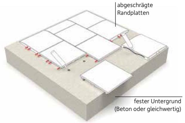
Verlegung (Halbverband) auf ebenem, festem Untergrund mit abgeschrägten Randplatten & Systemsteckern. Verklebung mittels Klebepunkten auf der Drainage.
